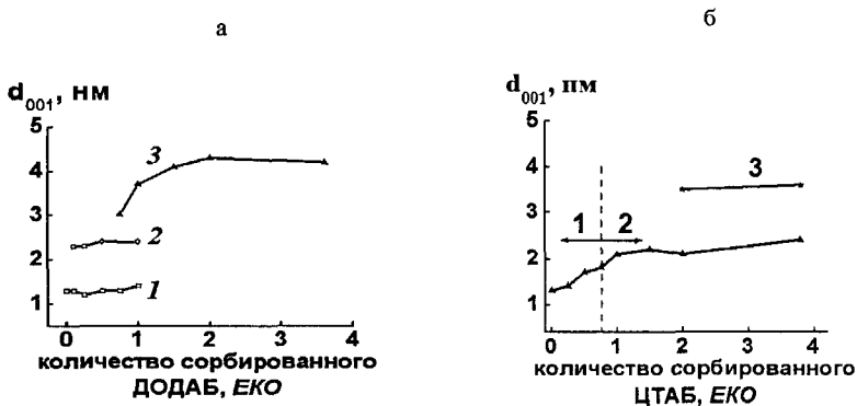
Рис. 4. Межпакетное расстояние в ММТ в зависимости от количества адсорбированного ДОДАБ (а) и ЦТАБ (б): а – планарные монослои (1), монослои парафинового типа (2), бислои парафинового типа (3); б – горизонтальные монослои (1), горизонтальный тройной слой (2), бислои парафинового типа (3).
