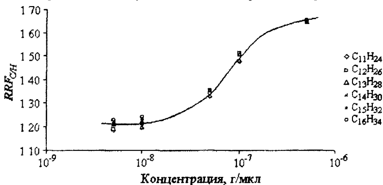
Рис. 1. Зависимость факторов RRF_{CH} от концентраций модельных углеводородов при общепринятом содержании кислорода в гелии ( n=3 , s_r = 0.003-0.023 )
