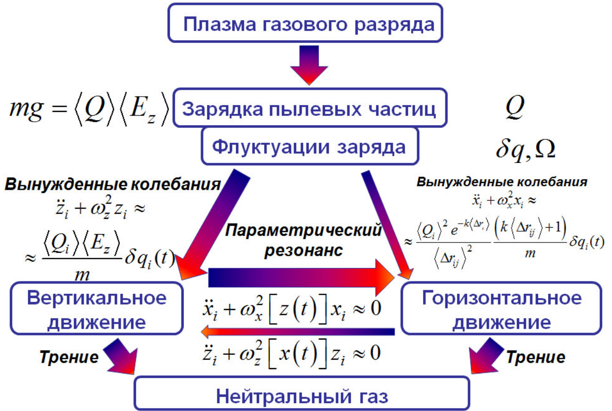
Рис. 2. Схема переноса энергии в системе пылевых частиц в плазме приэлектродного слоя газового разряда
